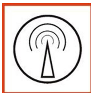
Figure 14 - Symbole selon la norme DIN 14034-6 signalant l'emplacement du FGB sur les plans d'intervention
