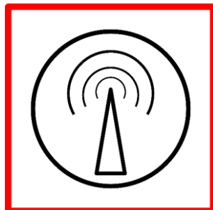
Figure 13 - Symbole selon la norme DIN 14034-6 signalant l'emplacement du FGB sur les plans d'intervention
