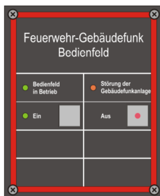
Figure 9- Tableau de commande selon la FGB-1FK-DIN14663 pour TMO-I4 et DMO
