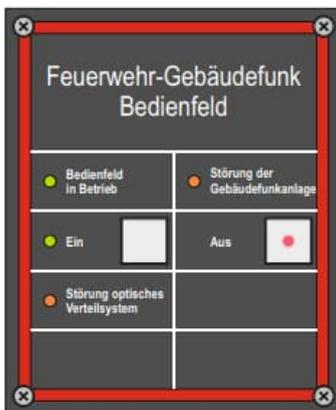
Figure 11- Tableau de commande selon la FGB-1FK-10V pour les installations avec un DAS avec distribution OMU/ORU
