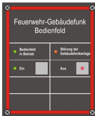
Figure 11- Tableau de commande selon la FGB-1FK-DIN14663
